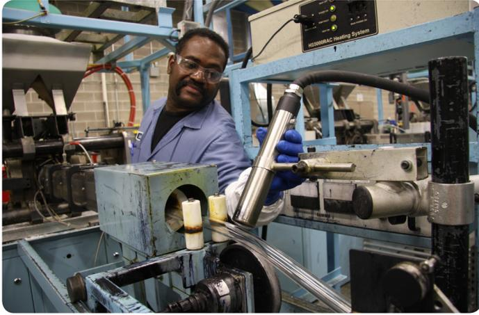
Uponor 操作员马克·摩根在调节 Videojet 1620 连续喷墨喷码机的喷头
